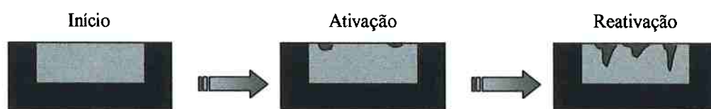
Figura 47: Esquema do aumento da área superficial do corpo de prova que sofre ataque
